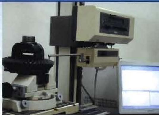
洗淨された部品から三次元測定機やコントレーサー（輪郭形状測定機）を使い、再度、再利用可能な部品を細部までチェックします。
