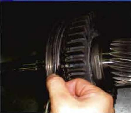
ピニオンギアのベアリングのプレーロードをトルクレンチにて正規の値に調整します。
